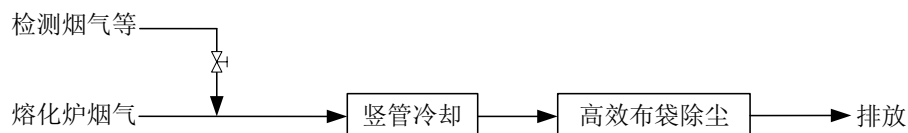
图 4.1-1 有组织废气处理工艺流程图
